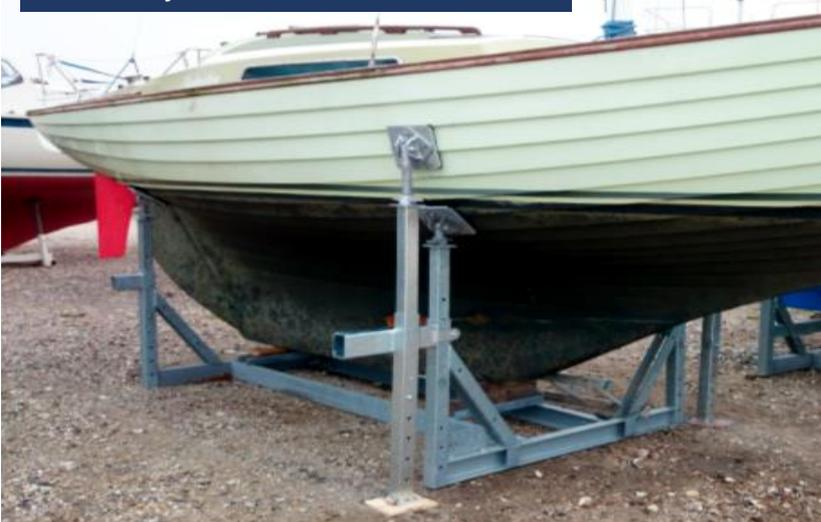
3 t Systembock mit zusätzlichen Zubehörteilen und Kielbalken aus Stahl
